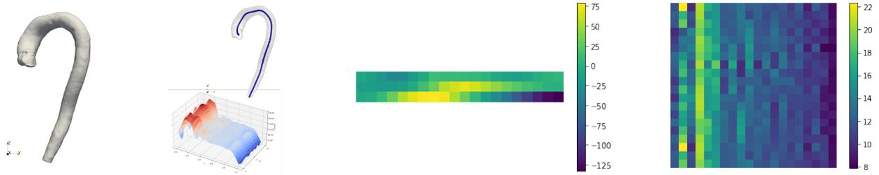
Figura 3.12: Diagrama de flujo de la obtención de los coeficientes de los B-Splines. Partiendo de la imagen médica obtenida a través de un TAC, siguiendo con la extracción del centerline y el mapa de distancias de la pared al centerline, terminando con los coeficientes de los B-Splines del centerline y del mapa de distancias.
